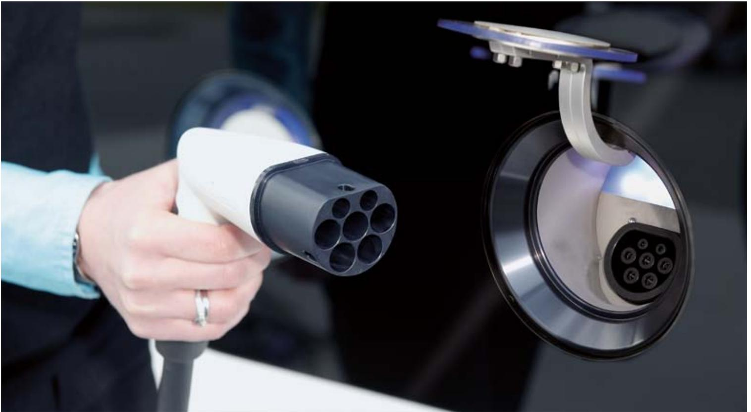
Außer der Ladung mit haushaltsüblichem Wechselstrom 230 VAC / 3,7 kW (Ladezeit für einen VW-UP ca. 6-8 h), kann die Ladung auch per AC-Stecker Typ 2 nach IEC 62196-2 mit 400 VAC und 43,6 kW Leistung erfolgen (Ladezeit VW-UP weniger als 30 min bei einer Reichweite von 150 km, Höchstgeschwindigkeit 130 km/h).
