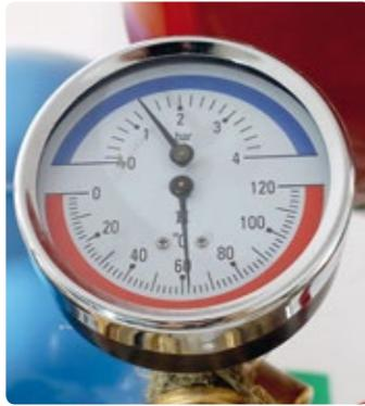
Als Maßnahme zur Verminderung des Legionellenwachstums sollte am Austritt von Warmwassererzeugungsanlagen idealerweise ständig eine Temperatur größer 60°C vorgehalten werden. Zudem sollte bei Anlagen mit Zirkulationsleitungen die Warmwassertemperatur im System nicht mehr als 5°C unter der Austrittstemperatur an der Warmwasseranlage liegen.
